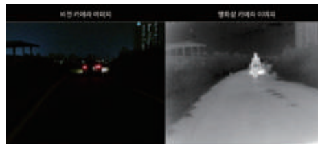
▲ 야간 상황에서 일반 비전카메라(좌측)와 셀플러스 열화상 카메라(우측)로 도로의 모습을 동시에 비교 촬영한 모습
