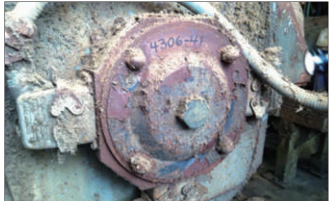
<그림1> 마그네틱 인코더는 먼지와 기름으로 덮여 있어도 효과적으로 작동한다.
