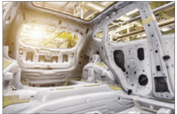
<그림9> 조립 과정에서 완성된 자동차 프레임과 차체 부분을 용접한다. 머신 비전은 이러한 용접부를 검사하고 확인할 수 있다.
