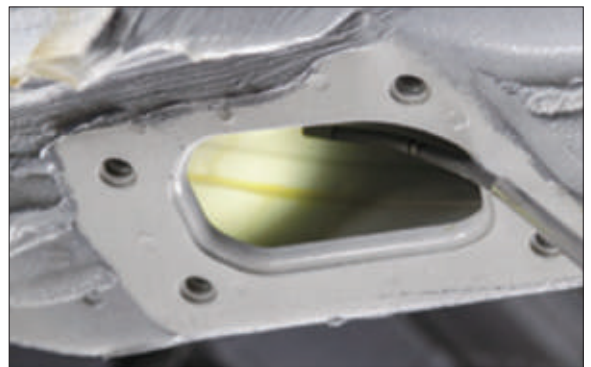
<그림10> 머신 비전 시스템을 사용하여 용접 품질을 검사할 수 있다.
