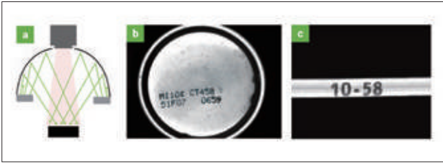
<그림3> a: 확산 돔 조명 기능 다이어그램, b: 인쇄를 읽을 수 있도록 표면 전체에 고른 조명을 보여주는 옴니한 소다 캔의 바닥, c: 유리 막대, 문자 읽기.
