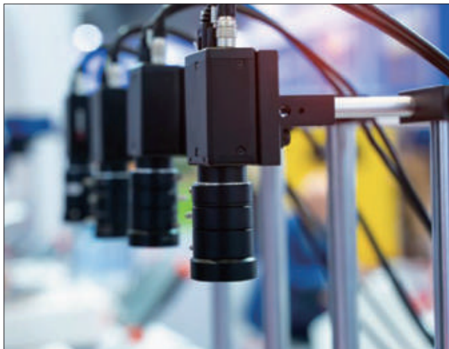
<그림3> IP 카메라가 이미지를 스마트 컨트롤러 PC로 전달한다.
