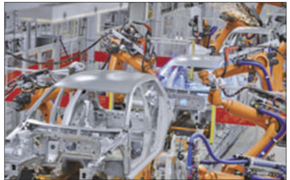
<그림8> 비전 가이드 로봇이 자동차 프레임에서 용접을 수행한 후 머신 비전 시스템은 용접을 검사해야 한다.
