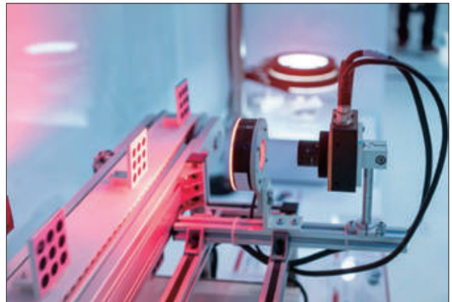
<그림2> 스마트 카메라가 모니터링 PC로 결정을 전달한다.
