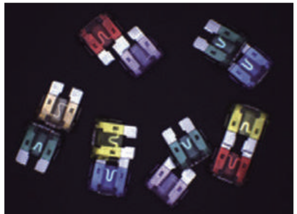
<그림2> 컬러 카메라를 활용하는 머신 비전 시스템은 퓨즈와 같은 전자 부품을 색상으로 식별할 수 있다.
