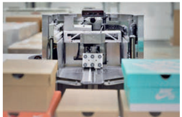
▲ FAULHABER 모터로 구동되는 진공 그리퍼 압에 의해 보관 및 회수가 수행된다.
