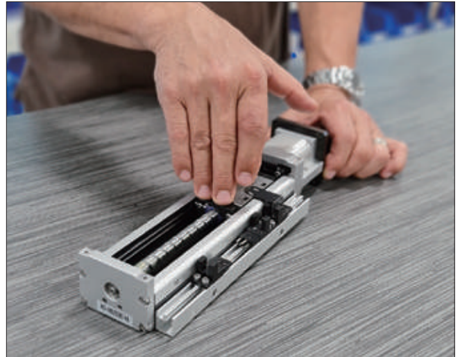
▲ NB Corp.의 BG 액추에이터의 최고 속도는 1500mm/sec이다. 가장 느린 액추에이터는 최소 185mm/sec를 이동할 수 있다.
