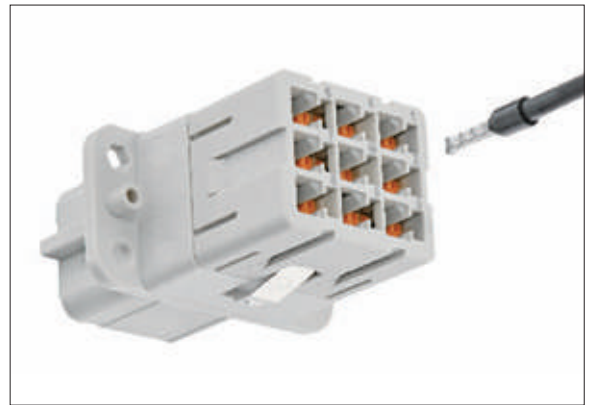
▲ push-in 기술 사용으로, 와이어 엔드 페룰 장착된 연선은 Han Q Mono-block에 틀 없이 손쉽게 연결 가능하다.
