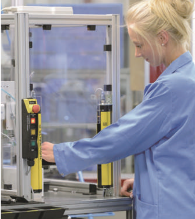
<그림3> 작업자는 안전 라이트 커튼으로 된 보호 장치와 상호 작용한다.
