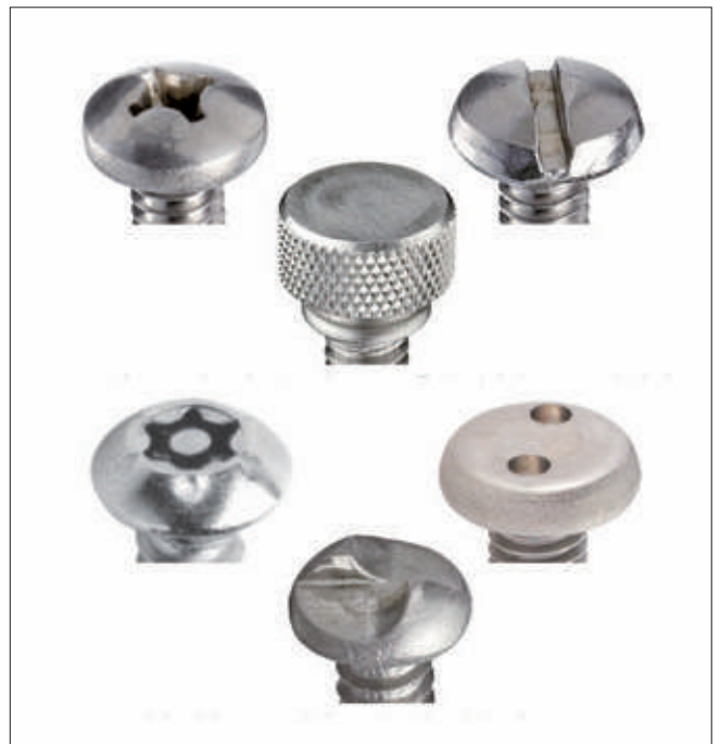
<그림2> 다양한 패스너의 예. <위의 3개 패스너> 분리를 위해 특별한 도구가 필요하지 않은 패스너. 홈이 있는 머리 나사와 엄지 나사는 쉽게 분리할 수 있다. <아래의 3개 패스너> 제거를 위해 특수 도구가 필요하므로 고정 가드를 고정하는 데 사용할 수 있는 변형 방지 나사의 예.
