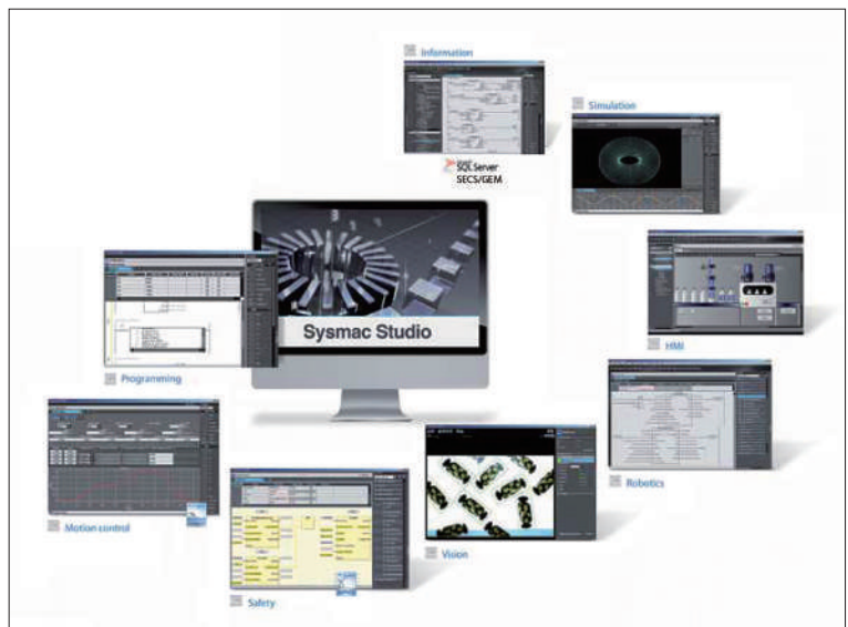
▲ Omron의 Sysmac Studio는 정보 처리, 시각화, 네트워킹, 로직, 모션, 안전, 비전, 로봇, CNC 및 I/O를 포함하여 완전한 자동화를 감당하는 가장 완벽한 기능을 갖춘 자동화 IDE 중 하나이다.
