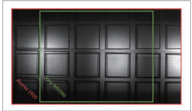
<그림9> IMX990의 1.3MP와 비교하여 업계 최고의 2.1MP 픽셀 수로 지원되는 Acuros 1920 카메라의 향상된 FOV를 보여주는 웨이퍼 실리콘 검사 대표 이미지
