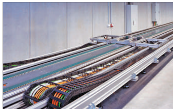
▲ 드래그 체인 케이블은 항상 이동 중이다. 높은 가속, 조밀한 굽힘 반경 및 지속적인 마모는 재료에 대한 지속적인 변형을 의미한다. Helukabel의 드래그 체인 테스트 시스템을 사용하면 다양한 이동 거리와 체인 반경을 적용할 수 있으므로 다양한 작동 조건에서의 시뮬레이션이 가능하다.
