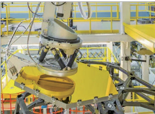
▲ PI 헥사포드는 로봇 암 끝단에서 제임스 웹 망원경의 18개 미러 세그먼트 중 하나를 정렬한다. (사진: NASA)
