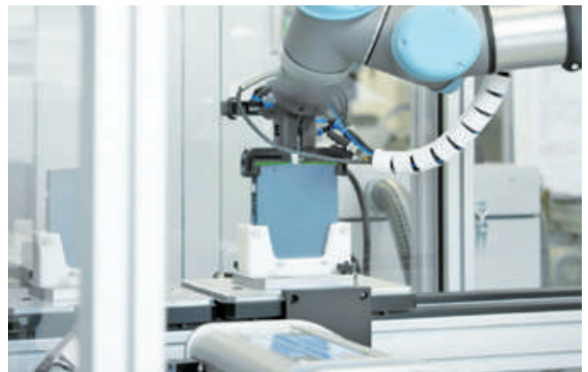
▲ 로봇 그리퍼의 경우 적층 제조 방식을 통해 컴팩트한 설계가 가능하고 기본 본체의 복잡한 진공 채널과 같은 상황에서의 응용을 구현할 수 있다.
