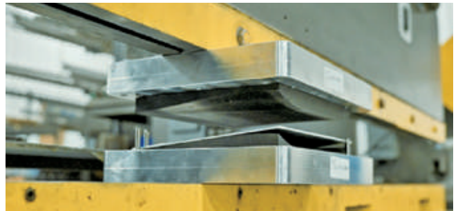
▲ 판금 부품이 3D 프린팅된 다이로 형성되기 직전의 모습.
