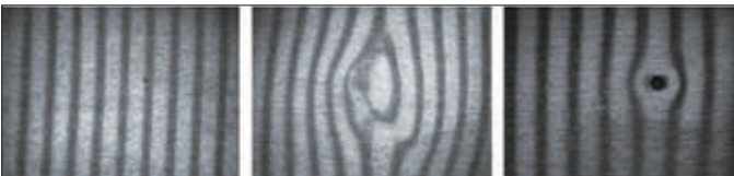
<그림7~9> 그림7에서 표면에 결함이 없는 것으로 보인다. 그림8에서는 작은 움푹 들어간 곳이 재료에 배치됐다. 반사광의 상대적인 밝기는 찌그러짐을 나타내지 않지만 PAL을 사용하면 결함이 분명하다. 그림9에서는 표면에 뾰족한 점이 있는 작은 움푹 들어간 부분이 배치되어 움푹 들어간 부분의 중심이 배경과 높은 대비를 보이면서 구부러진 부분 주변에서 선이 어떻게 갈라지는지 명확하게 보여준다.
