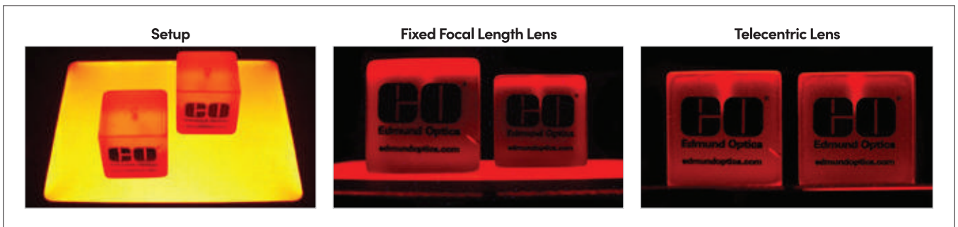
<그림2> Fixed Focal Length Lens의 angular field of view는 이미지에 parallax error를 유발하고 이로 인해 두 개의 육면체가 서로 다른 크기로 보이게 됨.
