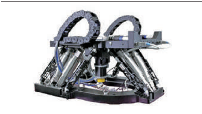
▲ 빔라인 애플리케이션을 위한 커스텀 헥사포드. 포지셔닝에 필요한 6개의 활성 스트럿 외에도 6개의 선형 인코더 장착 센서 스트럿이 추가로 설치되어 새로운 수준의 다축 정확도를 달성한다. (사진: PI miCos)
